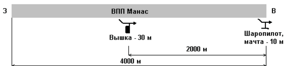
Рис. 3.1. Схематическое расположение анемометров и места выпуска шаропилотов относительно ВПП аэропорта «Манас»
