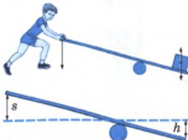
129-сүрөт. Рычагда аткарылган жумуштун бирдейлиги.
