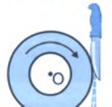
24-сүрөт. Айлана боюнча кыймылдын ылдамдыгы тик ылдый багытталган.
